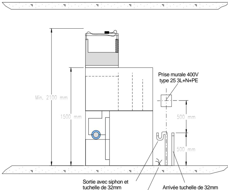
Sortie avec siphon et tuchelle de 32mm
