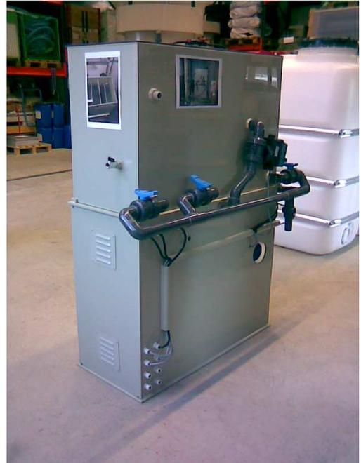
**SX9 Hinterseite, Entleerungssystem für die Wartung der oberen Behälter**
