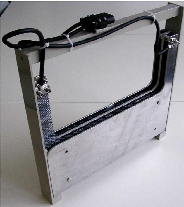
**Ein Elektrodenkoffer erzeugt das benötigte elektrische Stromfeld**
