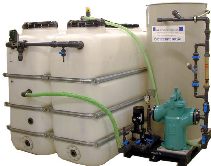
Installation FBR pour 5 m 3 par jour
